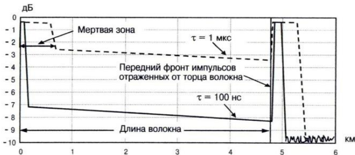
Рис. 2. Измерение длины волокна по сигналу отражения от конца волокна
