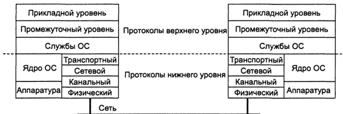
Рис. 3. Логическая многоуровневая организация распределенных систем
