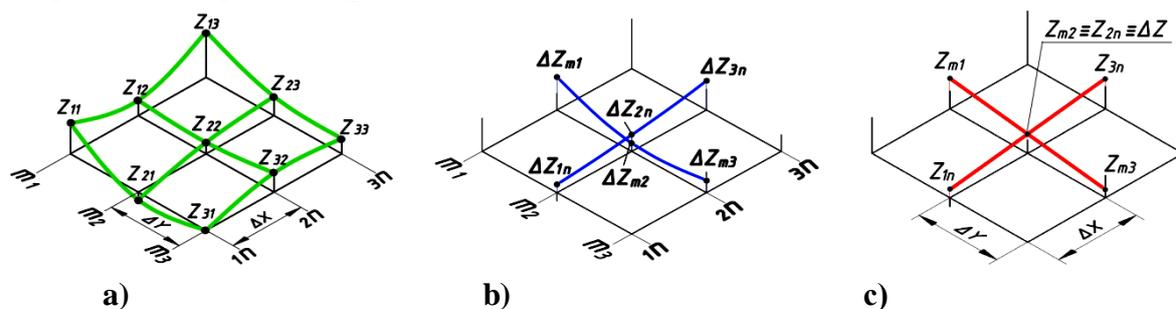
**Рис. 1. Определение плоскости среднего уклона квартала**
