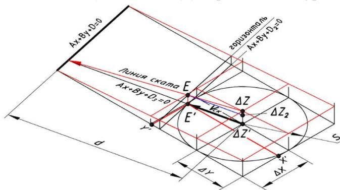
**Рис. 2. Визуализация стрелки вектора ската**
