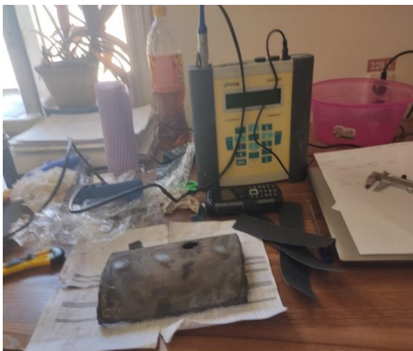
Рис.2. Результаты ультразвуковой толщинометрии:
