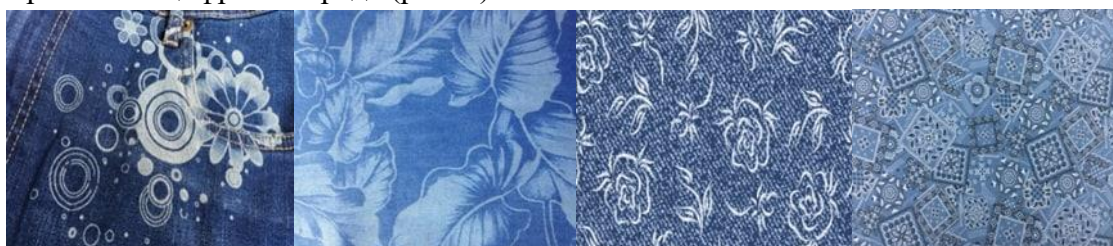
Рис. 7. Лазерная гравировка различных рисунков [20].
