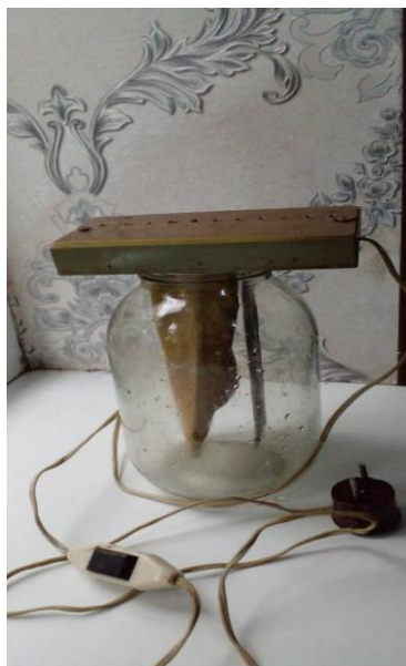
Фиг. 1. 1- баночка, 2- колпачка, 3- электроды, 4- диоды Д-231 или Д-232, 5- брезентовый мешочек, 6- катод (мертвая вода), 7- анодная («живая» вода).
